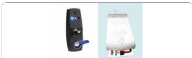
Obr. 11 Čtečky kontaktních čipových identifikačních médií: a) iButton® čtečka b) čtečka čipových karet
